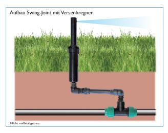
das Rohr gelangen, welche später die Regner verstopfen können. Lassen Sie hierzu das Ende des PE-Rohrs offen, spülen es durch und installieren Sie anschließend die Regner.
